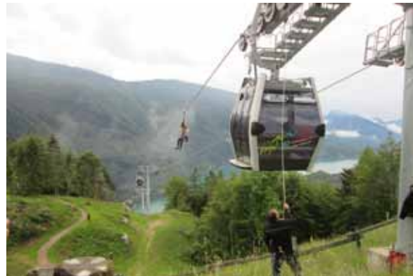
Prove di soccorso in linea tramite calata
