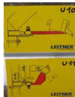
Controllo di sagoma: nella figura sotto, U9, U10, U11 controllo geometria della morsa chiusa
