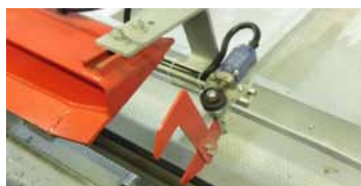
Elica di manovra con cella di carico
