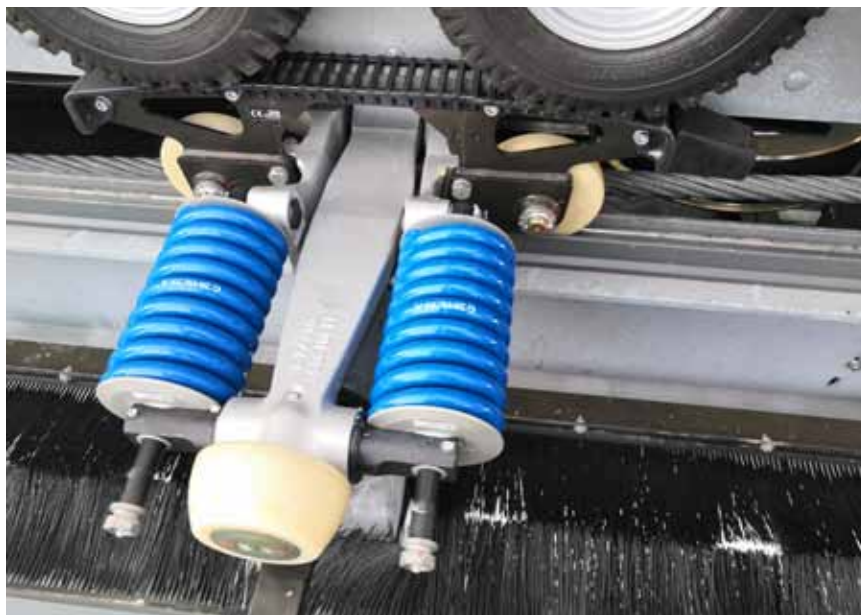
Morsa di un veicolo ad ammortamento temporaneo
