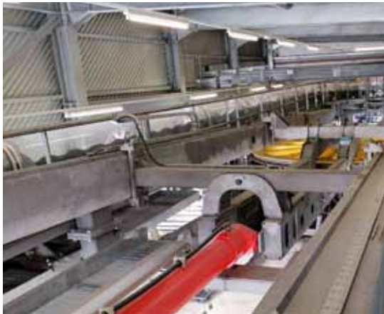
Sistema di tensionamento di tipo idraulico a pistone singolo Sistema di tensionamento di tipo idraulico a doppio pistone
