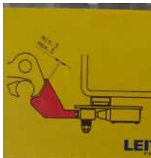
Controllo di sagoma: nella figura sotto, U9, U10, U11 controllo geometria della morsa chiusa
