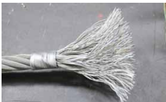
Dettaglio di un attacco di estremità a testa fusa
