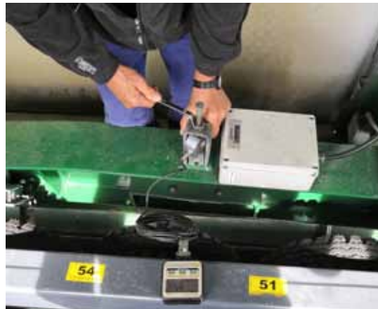
Taratura o verifica della cella di carico del dispositivo provamolte
