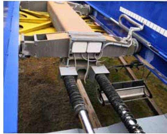
Sistema di tensionamento di tipo idraulico a pistone singolo Sistema di tensionamento di tipo idraulico a doppio pistone
