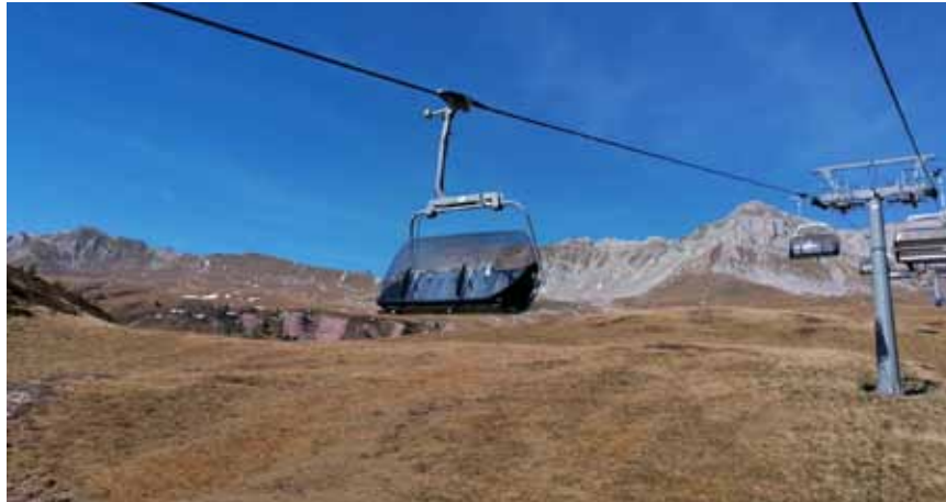
Seggiola di un impianto ad ammassamento automatico
