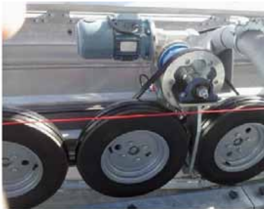
Spaziatore con riduttore epicicloidale e motore asincrono a velocità fissa
